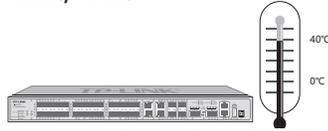
为保证交换机长期稳定工作，延长使用寿命，请维持环境一定的温度和湿度。过高或过低的环境湿度易引起绝缘材料漏电、变形甚至金属部件锈蚀现象，温度过高会加速绝缘材料的老化过程，严重影响设备使用寿命。该系列交换机的正常工作和存储温度/湿度如下表2-1。
