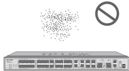
灰尘落在交换机表面会造成静电吸附，使金属接点接触不良。虽然设备本身在防静电方面做了一定措施，但当静电超过一定强度时，仍会对内部电路板上的电子元器件造成致命的破坏，为避免静电影响设备正常工作，请注意以下事项：
