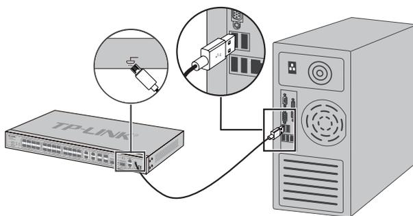
图3-4 Micro USB Console端口连接示意图
