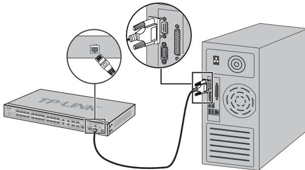
图3-3 RJ45 Console端口连接示意图
