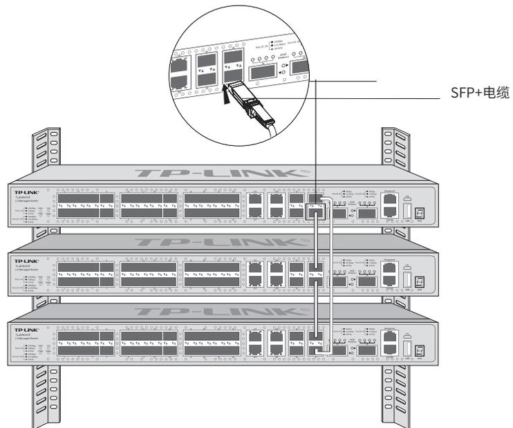
图2-4 使用SFP+端口建立堆叠示意图
