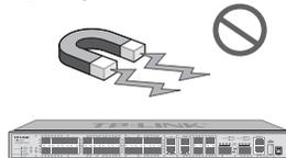
电磁干扰会以电容耦合、电感耦合、阻抗耦合等传导方式对设备内部的电容、电感等电子元器件造成影响，为减少电磁干扰因素造成的不利影响，请注意以下事项：
